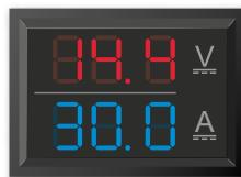
Das Ladegerät JCC12/30VA verfügt über ein Display, das während des Ladevorgangs Spannung und Strom anzeigt.
